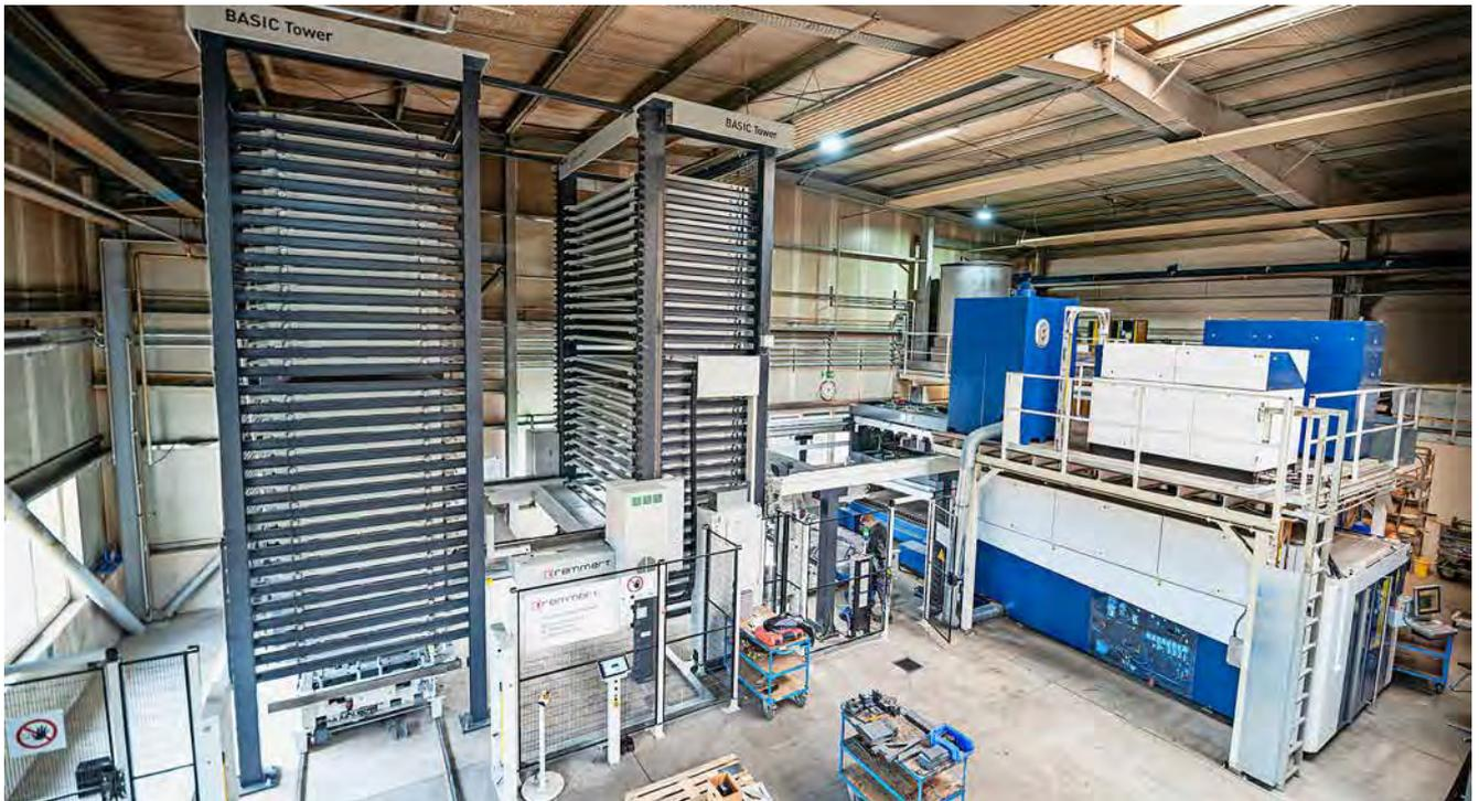
Das Blechlager mit Laserautomation, der Laserflex und der Laserschneider arbeiten vollautomatisch, effizient und schnell zusammen.
