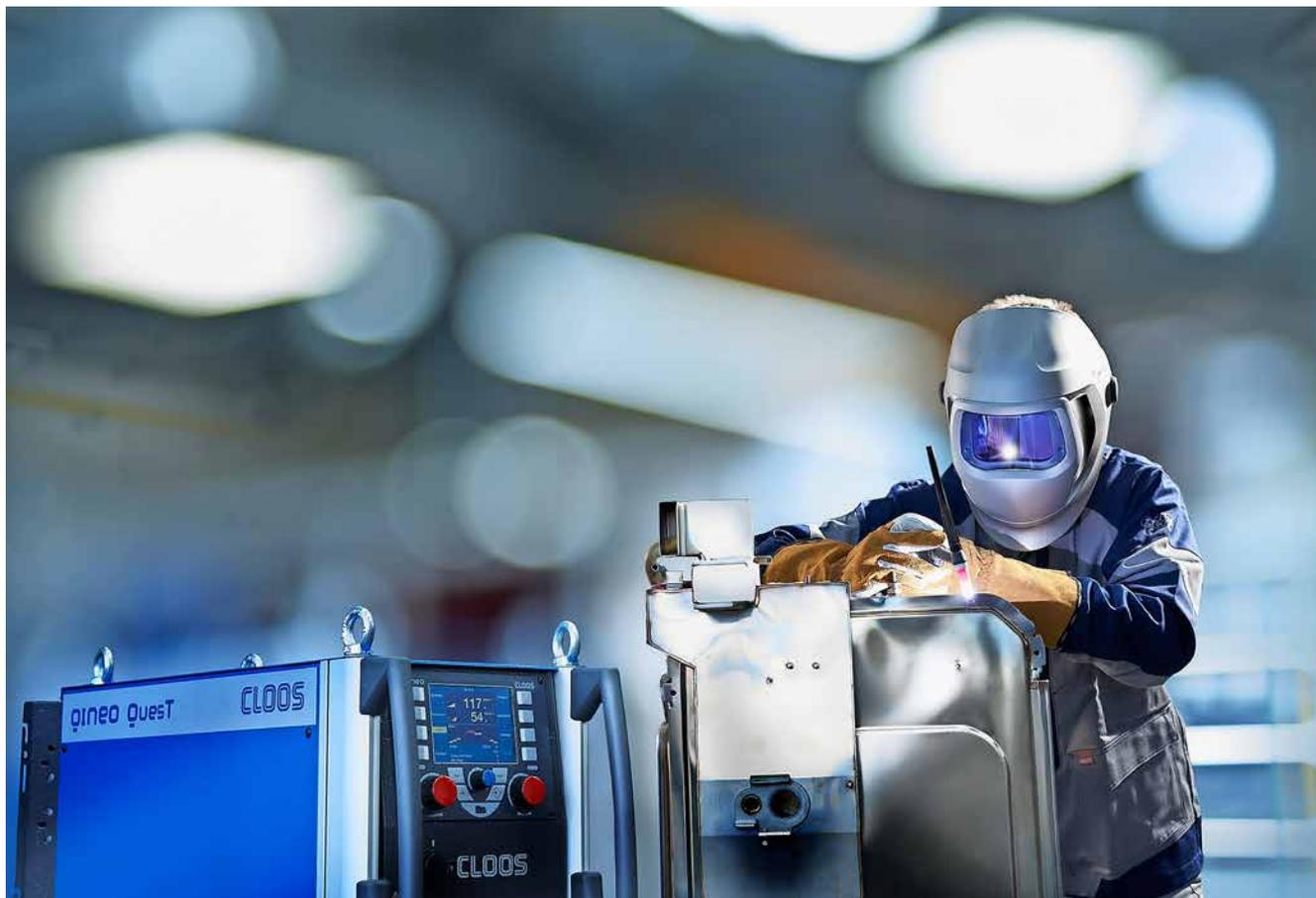
Die neue Schweißstromquelle Qineo Quest wurde speziell für hochanspruchsvolle WIG-Aufgaben entwickelt.
