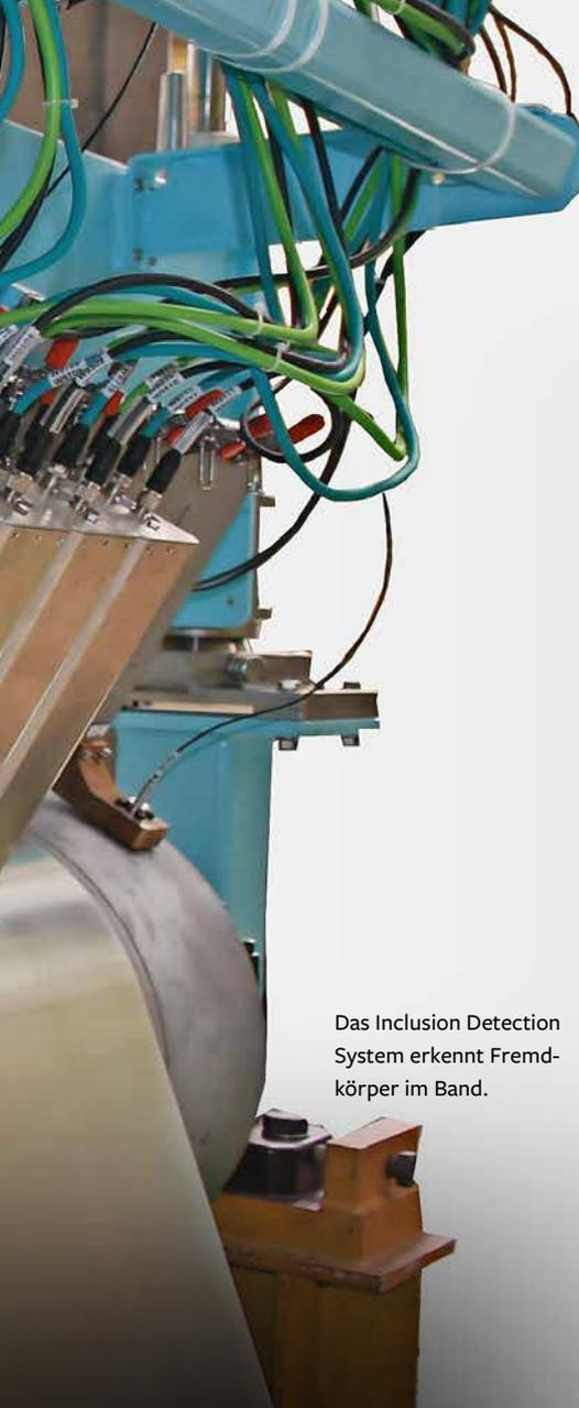
Das Inclusion Detection System erkennt Fremdkörper im Band.
